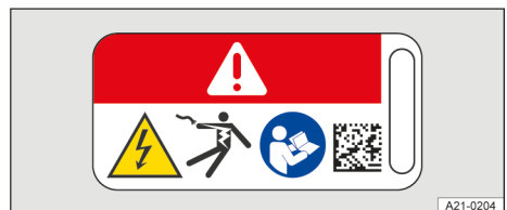
Joonis 4 Hoiatussilt kõrgepingekomponentidel.
