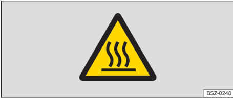
Joonis 6 Kuumade pindade hoiatussilt laadimisseadmel.
