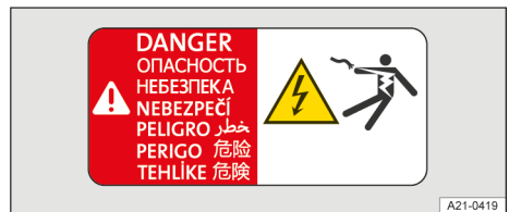
Joonis 3 Hoiatussilt kõrgepingekomponentidel.
